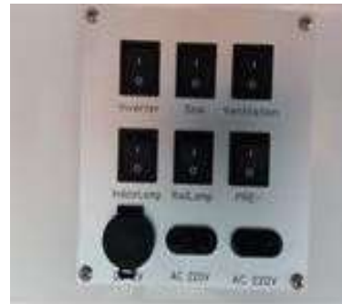
Контрольная панель с розеткой переменного тока
